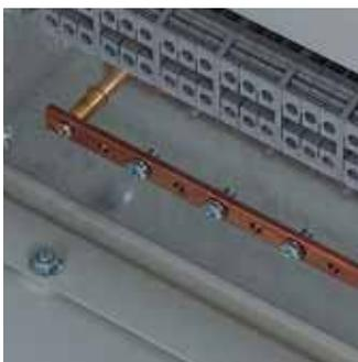
Шины изготовлены из электротехнической меди с отверстиями под болты М6 с шагом 25 мм. Устанавливается на монтажную плату с помощью изоляторов.
