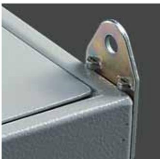
Петли позволяют осуществить крепление боксов SR2 к стене. На задней части бокса предусмотрены отверстия для крепления. Сами петли изготовлены из оцинкованной стали толщиной 2,5 мм.
