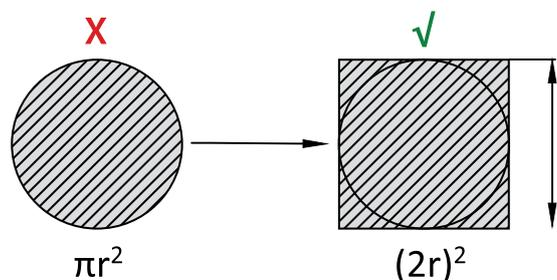
Полезное сечение одного кабеля умножается на количество кабелей в лотке, что определяет площадь поперечного сечения лотка с учетом заполняемости лотка, полученная величина увеличивается на 25% для обеспечения возможности добавить кабели в лоток в случае необходимости развивать систему.
