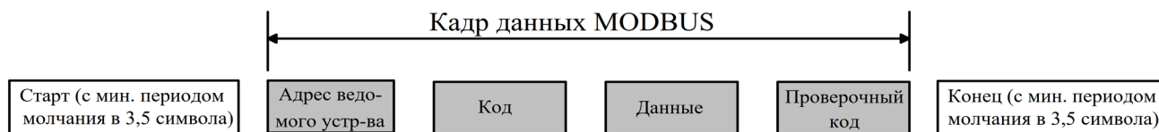
А-рисунок 1-2 Формат сообщений Modbus RTU
