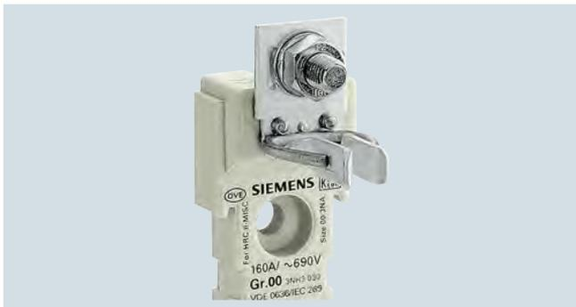
Плоские клеммы с винтами предназначены для присоединения сборных шин или кабельных наконечников. Винтовое соединение защищено от самооткручивания. В нем используются плоская шайба, пружинная шайба и гайка. Ввиду значительной длины рычага при затягивании гайки следует обращать внимание на соблюдение момента затяжки.
