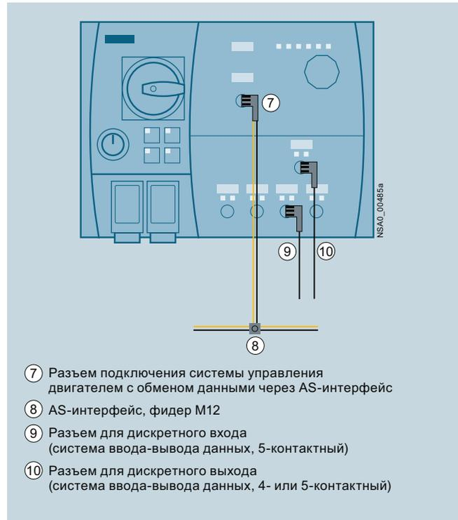
Подключение устройств обмена данными посредством AS-интерфейса и дискретных входов и выходов.
