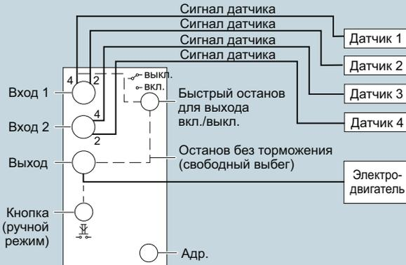
Вариант 2: Подключение макс. к двум датчикам с индикацией загрязнения
