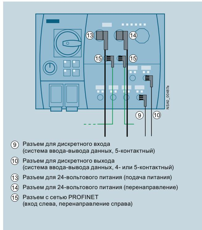
Подключение устройств обмена данными посредством сети PROFINET и дискретных входов и выходов.
