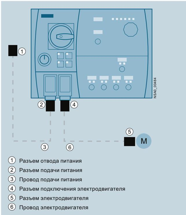
Подключение электропитания и электродвигателя на пускателе электродвигателей M200D (на примере M200D для AS-интерфейса).
