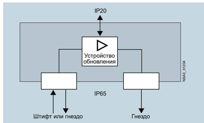
Гибридное соединение полевой шины в качестве активного кабельного ввода коммутационного шкафа с функцией обновления.
