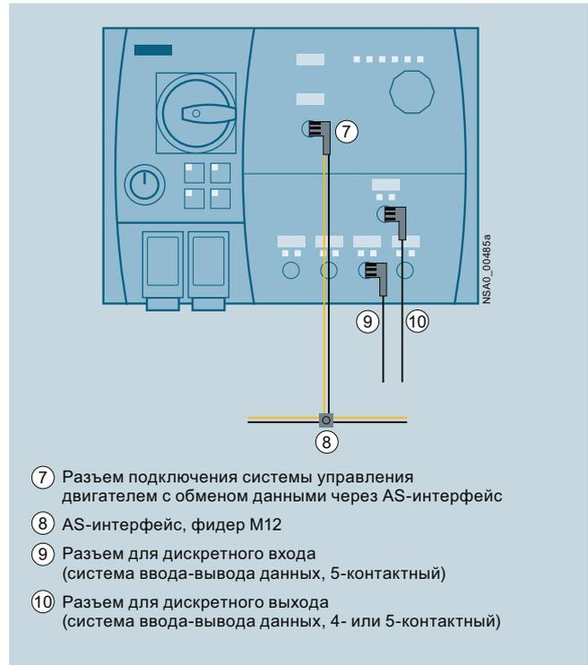
Подключение устройств обмена данными посредством AS-интерфейса и дискретных входов и выходов.
