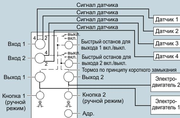
Вариант 2: Подключение макс. к двум датчикам с индикацией загрязнения
