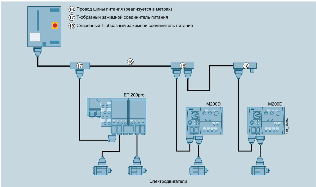
Электропитание электродвигателей через шину питания с подсоединенными с помощью проводов шины питания Т-образным зажимным соединителем или сдвоенным Т-образным зажимным соединителем питания, тупиковыми проводами к полевым устройствам (пускателям электродвигателей) и проводом передачи питания к электродвигателям через соединительные провода электродвигателей.
