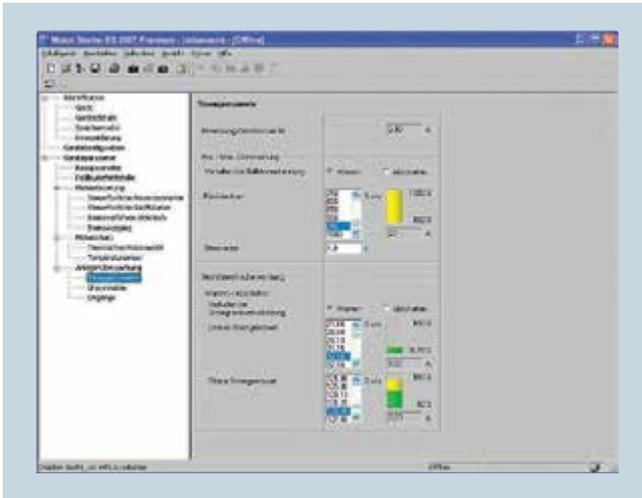
Motor Starter ES для параметрирования, наблюдения, диагностики и проверки пускателей электродвигателей.
