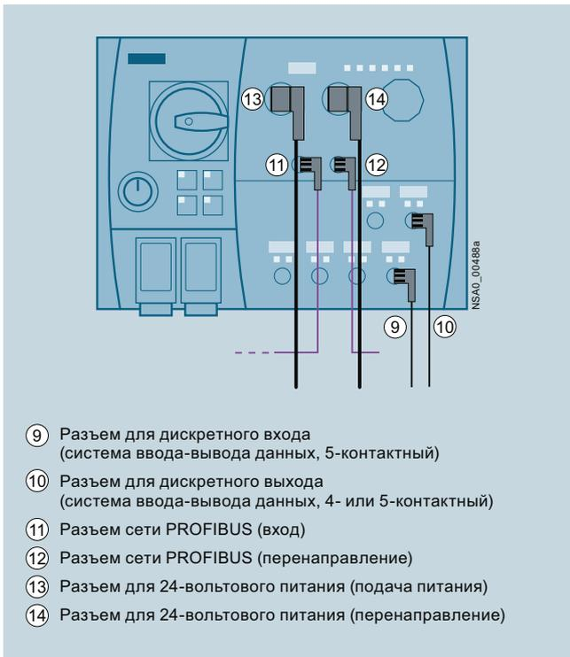
Подключение устройств обмена данными посредством сети PROFIBUS и дискретных входов и выходов.
