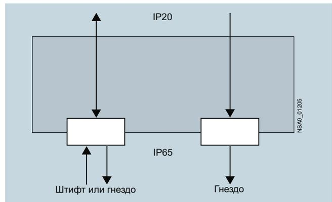
Гибридное соединение полевой шины в качестве пассивного кабельного ввода коммутационного шкафа.
