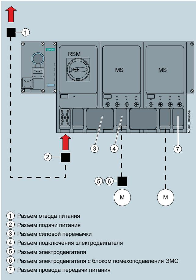
Принципиальная схема варианта ET 200pro (слева) с подключаемым модулем для IM, интерфейсным модулем для обмена данными (IM), модулем ремонтных выключателей RSM, двумя пускателями электродвигателей ET 200pro (MS) и разъемами для подачи электропитания.
