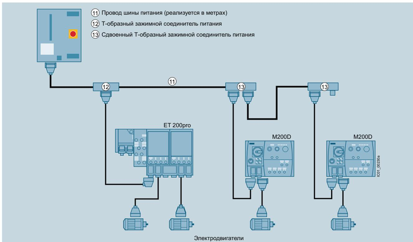
Электропитание электродвигателей через шину питания с подсоединенными с помощью проводов шины питания T-образным зажимным соединителем или сдвоенным T-образным зажимным соединителем питания, тупиковыми проводами к полевым устройствам (пускателям электродвигателей) и проводом передачи питания к электродвигателям через соединительные провода электродвигателей.
