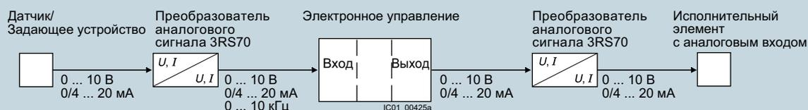
Пример использования для обработки аналогового сигнала
