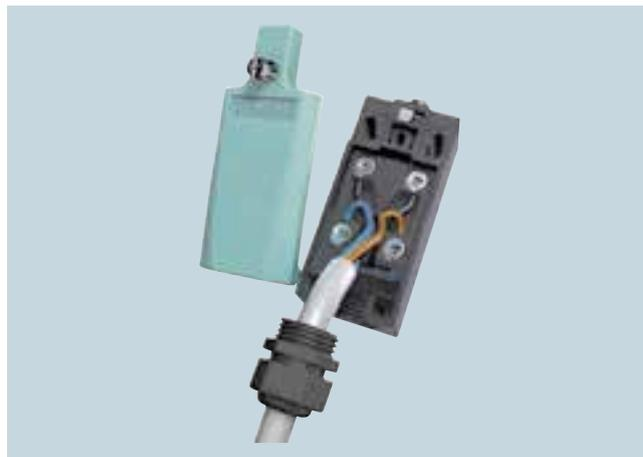
Данные позиционные выключатели в качестве дополнительного преимущества для клиента позволяют просто и быстро выполнять подключения. В данном случае соединительный провод сначала подключается к клеммам переключающего элемента и затем через прорезь выводится в резьбовое отверстие. Благодаря этому способу подключения экономия времени составляет примерно от 20 до 25%.
