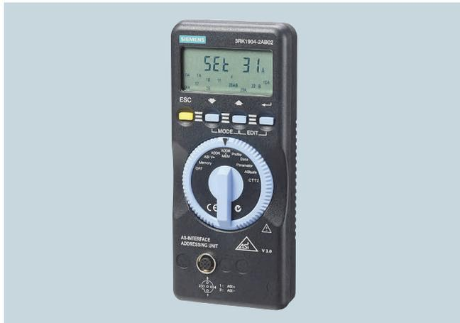
Обновленное устройство адресации для AS-Interface согласно спецификации AS-i 3.0
