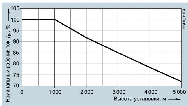
При установке на высоте более 2000 м максимально допустимое рабочее напряжение снижается до 460 В.
