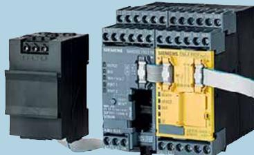
Модули расширения DM-F Local и DM-F PROFIsafe системы SIMOCODE для безопасного отключения электродвигателей (обеспечивается уровень до SIL 3/PL e)
