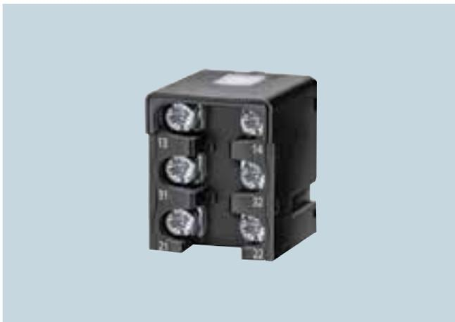
Трехконтактный переключающий элемент с контактами мгновенного или замедленного действия обычно имеется для всех форм корпусов. Он подходит для того же места монтажа, что и двухконтактный элемент. Исполнение с 1 НО + 2 НЗ дает, например, больше безопасности за счет резервного отключения (2 нормально закрытых контакта) с одновременной сигнализацией (нормально открытый контакт). Трехконтактные элементы предлагаются также с перекрытием и с 2 НО + 1 НЗ.
